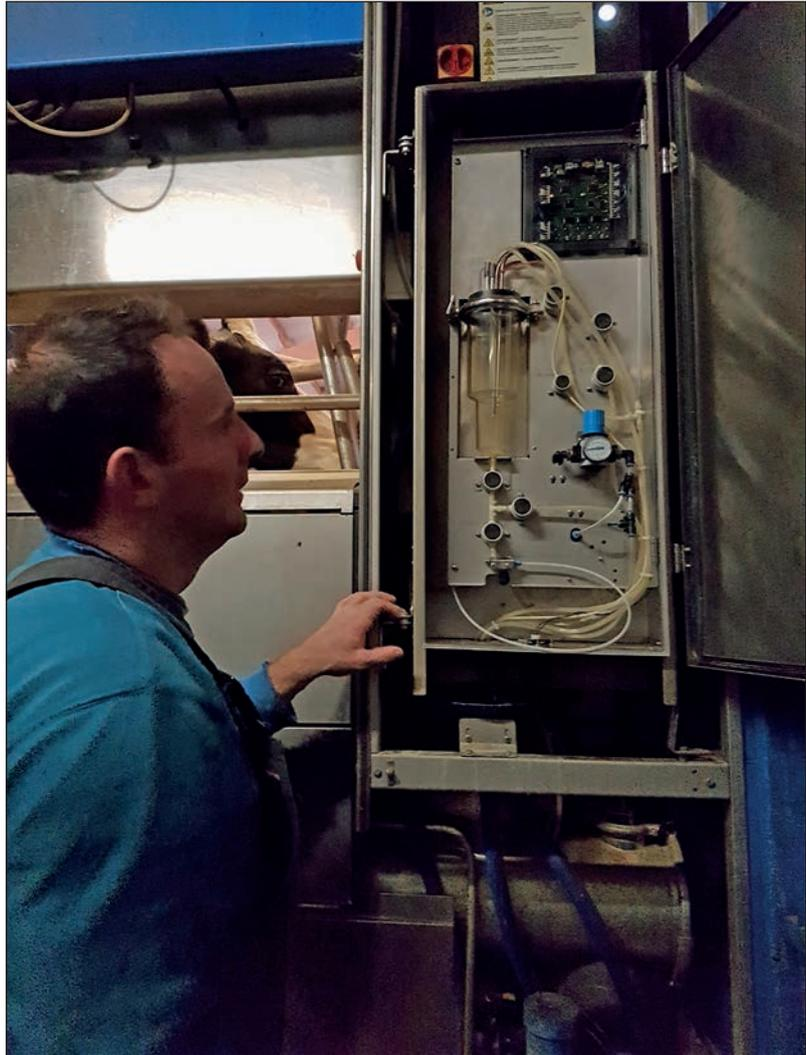
Milchprobeentnahme durch den Roboter beim Melken
